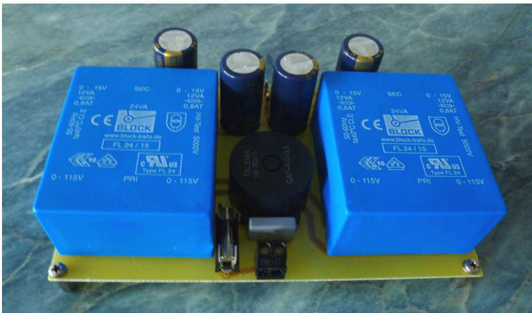
Netzteil – Platine mit kanalgetrennter Spannungsversorgung und 230 Volt Netzspannungs-Filter
