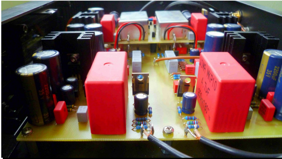
Blick auf die Phono ONE Ausgangsverstärkerstufen. Gut zu erkennen sind die beiden großen WIMA-Koppelkondensatoren, denen noch hochwertige Roederstein Polypropylenkondensatoren parallel geschaltet sind.
